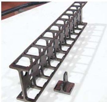
I形鋼から切り出した部材の例。 安価で手軽に加工できます。
