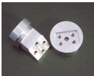
立形5軸マシニングセンタを使った試作品
