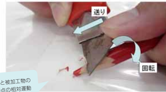
図2 切削の原理 (鉛筆削り)
