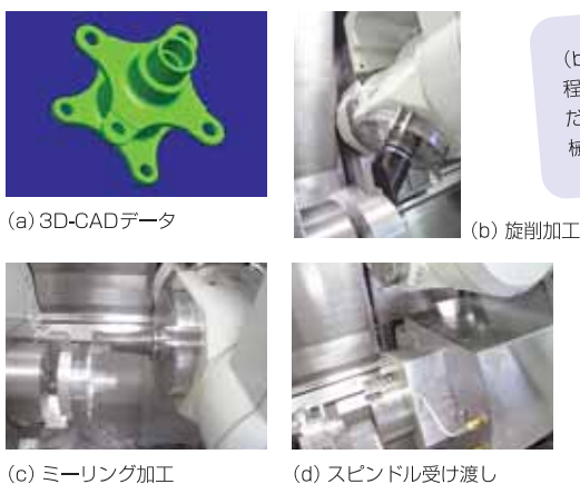
図3 MTMによる加工の様子
