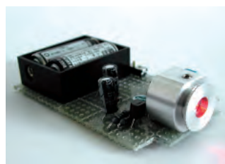
電気クラフトはレーザーポインタを作る事を目標としてプリント基板作成やハンダ付け
