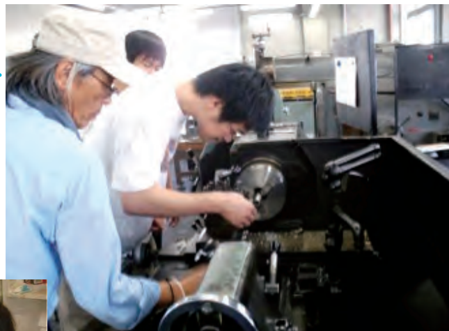
機械クラフトでは旋盤を用いた金属材料の切削とねじ切り
